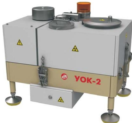
Принцип работы УОК-2 основан на использовании свойства алмазов люминесцировать под действием рентгеновского излучения и различия этих свойств у алмазов и сопутствующих люминесцирующих минералов. Реализована возможность одновременного определения характеристик при регистрации люминесценции объекта как со стороны облучения, так и со стороны, противоположной облучению.
